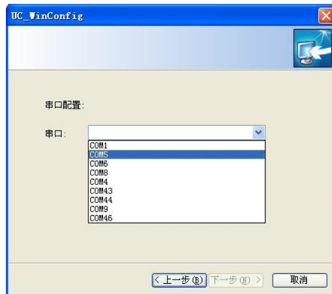
图 6-4 串口方式升级
