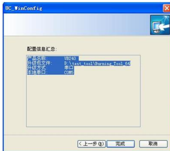
图 6-6 串口方式升级配置信息
