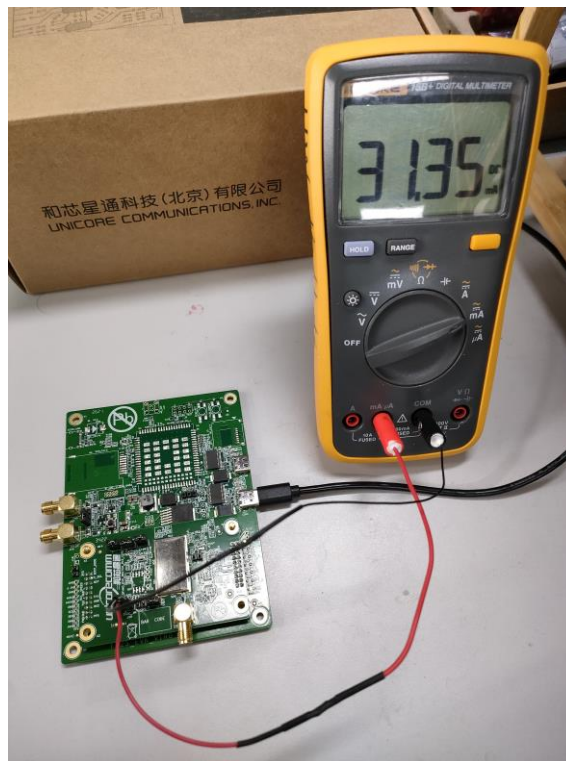
图 4-2 DCDC_IN 连接示例
